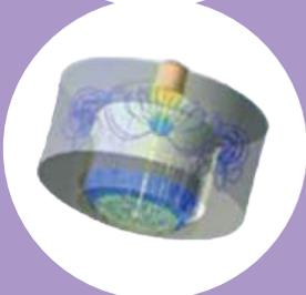
Bubl'air Wash est un mécanisme de prolongation de la durée de vie des filtres qui introduit un flux turbulent pendant la filtration pour empêcher les particules de se trouver complètement emprisonnées sur la membrane.
