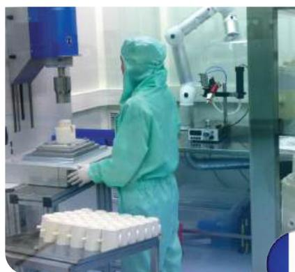
Les filtres FILT'RAY sont montés et assemblés en France à partir de matières plastiques élaborées et moulées également en France. La production répond aux certifications hygiène et qualité les plus rigoureuses (ISO 9001 et ISO 13485). L'ensemble des étapes d'assemblage est réalisé en salle blanche de classe ISO 7.
